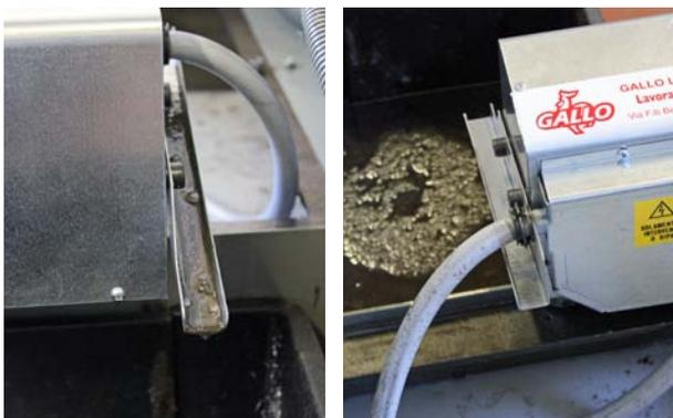
La gomma galleggiante (diametro 16 mm) estrae l'olio non emulsionato che si trova in superficie e permette un'ottima efficienza anche quando il livello dell'emulsione in vasca è al minimo. Vagando liberamente sulla superficie riesce a raggiungere punti dove altri sistemi non arrivano.
